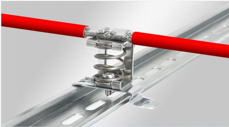
Les étriers de serrage de blindage CEM sont utilisées partout où le blindage des câbles individuels doit être relié au potentiel de masse. Les étriers de serrage de blindage assurent un raccordement sûr et simple du blindage du câble.
